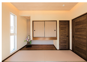
和室の天井を下げて仕込んだサイドライトは、白壁に反射して明るさを増す緻密な計算がなされている
